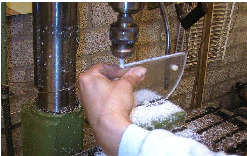
Figure 7. Gravure des sillons dans les demi-disques de plexiglas.
